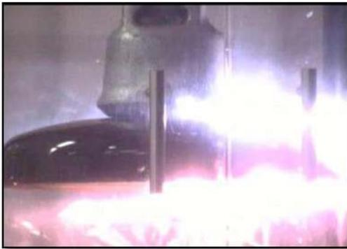
Gambar 13 b Proses perambatan arus pada saat terjadi tegangan tembus pada isolator
