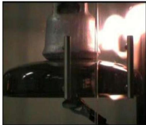
Gambar 15 Perambatan arus pada tegangan tembus isolator dengan kondisi basah
