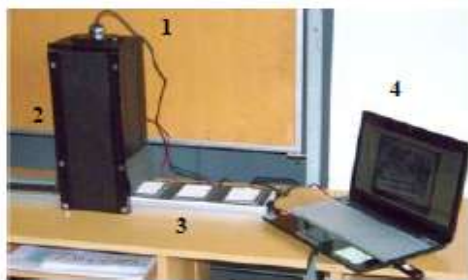
Keterangan : 1. Mikroskop-CCD digital 2. Kotak hitam dengan iluminator LED putih 3. Plat contoh 4. Komputer
