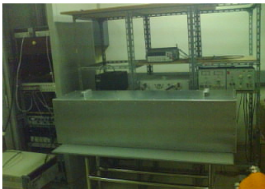
Gambar 3c Tata Letak Rangkaian Pengukuran dengan Perisai Sangkar Faraday
