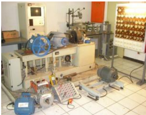
Gambar 6 Set-up Uji Prototip GMP dengan Beban Lampu dan Tahanan Air serta Instrumen Ukurnya
