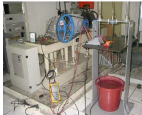
Gambar 6 Set-up Uji Prototip GMP dengan Beban Lampu dan Tahanan Air serta Instrumen Ukurnya
