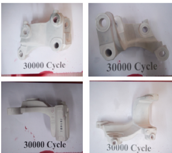
Gambar 16 Hasil inspeksi dye penetrant pada spesimen 30.000 siklus.
