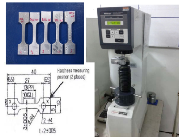
Gambar 3 Spesimen dan mesin uji hardness .
