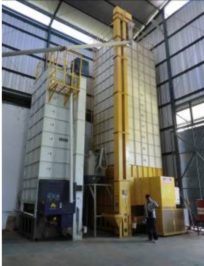
Gambar 2 Mesin pengering tipe resirkulasi di RPC Mukomuko.
