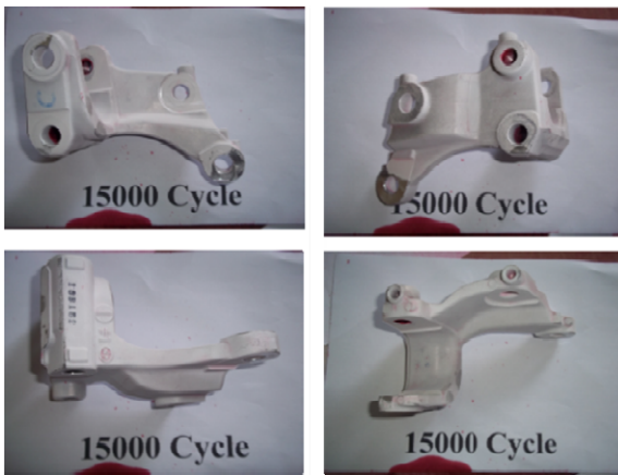
Gambar 15 Hasil inspeksi dye penetrant pada spesimen 15.000 siklus.
