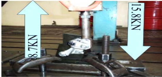
Gambar 14 Set-up pembebanan uji dinamik komponen bracket torque rod .
