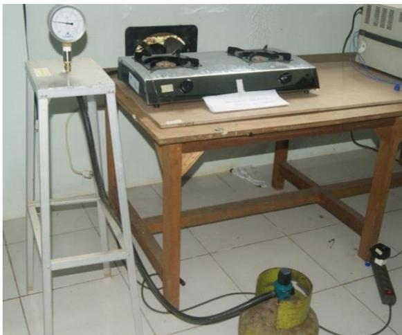
Gambar 1 Skema pengukuran asupan panas kompor gas.
