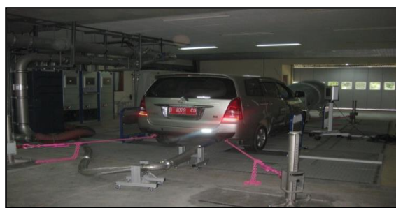
Gambar 4 Fasilitas uji emisi kendaraan R83-05 BTMP-BPPT.
