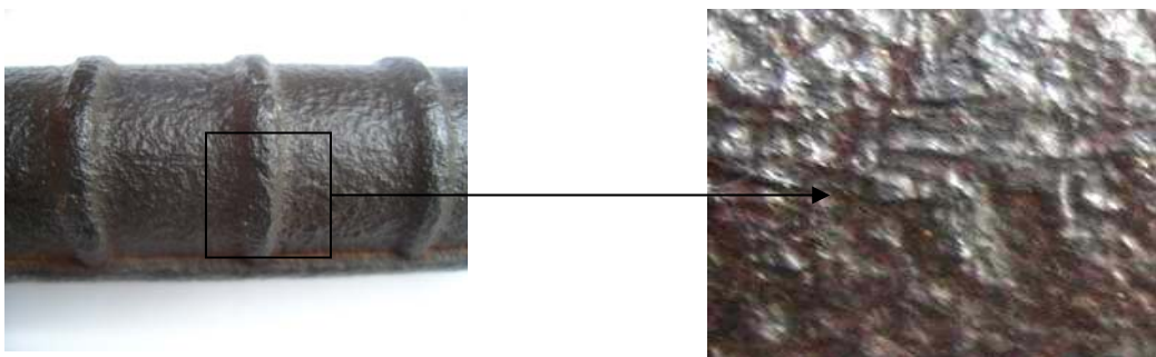
Gambar 2 Produk Korosi pada Permukaan Baja Tulangan yang Terkorosi Selama Sepuluh Tahun
