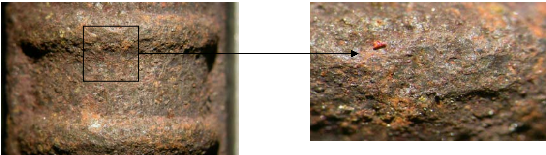
Gambar 2 Produk Korosi pada Permukaan Baja Tulangan yang Terkorosi Selama Sepuluh Tahun
